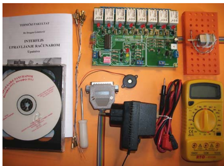
Slika 7: ELEKTRONSKO INFORMATIČKI NASTAVNI SISTEM „INTERFEJS“: a) priključen na računar, b) sastav INTI - elektronska ploča, mikromotor, zujalica, vezni provodnici, odvrtka, univerzalni elektro instrument, CD sa programima i uputstvom
